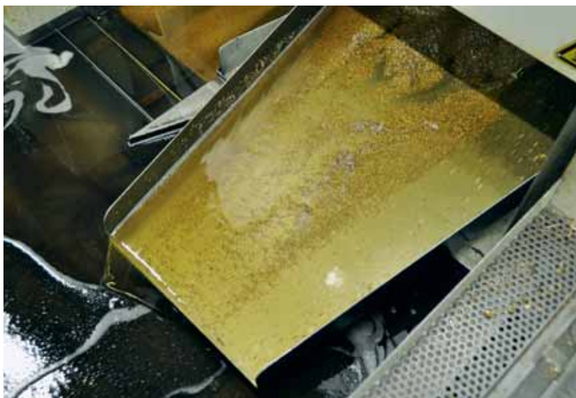
Spånor produceras tonvis under tillverkningsprocessen hos BEC. Återanvändning av dessa och återvinning av skäroljan som används är avgörande för priskalkyleringen.
