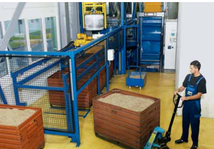
Bytet till en enda skärolja gjorde det också oljeåtervinningen enklare genom att använda den helautomatiska spåncentrifugen.
