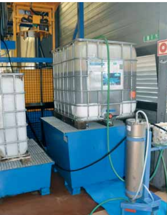
Återvunnen skärolja renas genom ett filtreringssystem och tillförs verktygsmaskinerna tillsammans med en andel ny olja.
