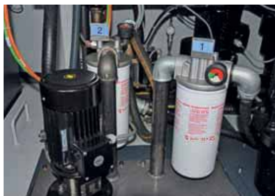
Tillsammans med bandfiltret har MultiSwiss 6x14 även flera invändiga filter som filtrerar oljan till en finhet på 5 µ. Detta är speciellt viktigt för den hydrostatiska monteringen av de sex spindlarna.
