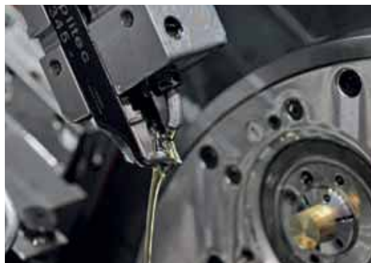
Motorex Ortho NF-X är idealiskt lämplig för alla de flerspindliga maskiner som är i bruk hos RB-Cema. Tornos MultiSwiss 6x14 utvecklades med NF-X och använder skäroljan i ett brett funktionsområde.
