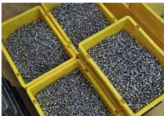
Kvaliteten synliggörs tack vare den dokumenterade kontrollen av samtliga produktionssatser. Tillsammans med vikten definieras även ytkvaliteten (Rz-värde = korrugering och grovhet).
