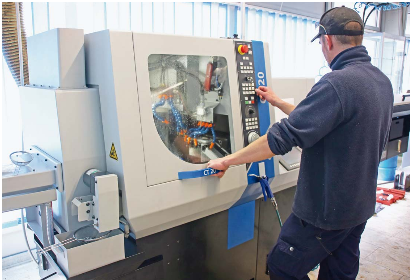
Der neue Drehautomat CT20 bewältigt mit seinen 26 Werkzeugplätzen komplexere Bearbeitungsvorgänge und kann mannlos durcharbeiten (Foto: Klaus Vollrath)
