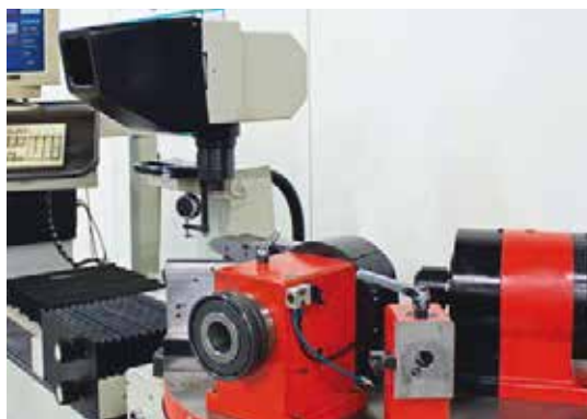
Les outils qui ont été préréglés avec précision dans la station de réglage peuvent être chargés dans la machine et réglés là en seulement quelques étapes simples.
