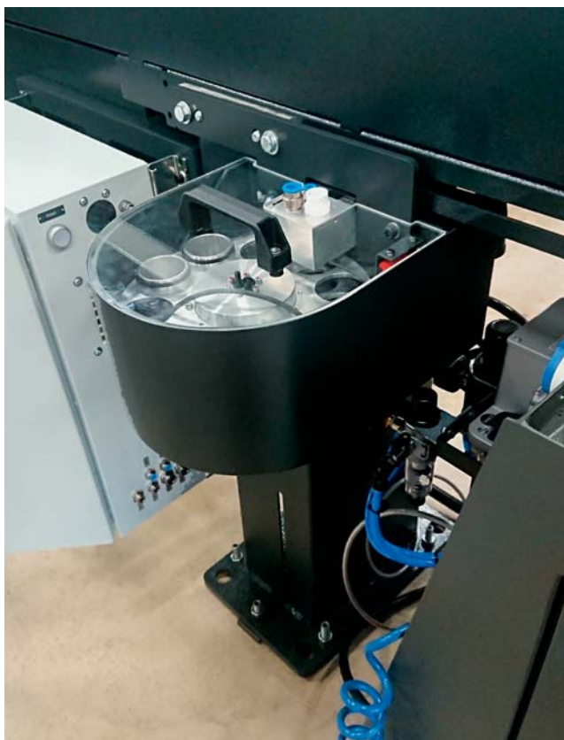
Un carosello a vuoto sviluppato appositamente da Tornos per il recupero affidabile di pezzi ultra-piccoli grazie a un sistema di aspirazione controllata.
