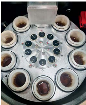
Un carosello a vuoto sviluppato appositamente da Tornos per il recupero affidabile di pezzi ultra-piccoli grazie a un sistema di aspirazione controllata.
